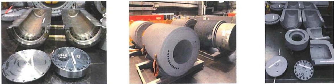
図1 無条件開放された（再利用）CASTOR®S1 キャスクの部材 1)
